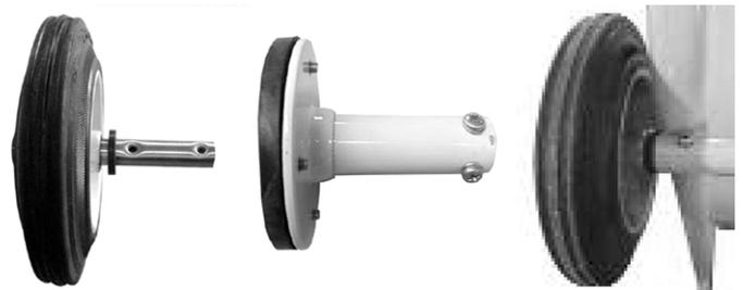
3. Entfernen Sie die Schrauben von dem Radaufbau.
